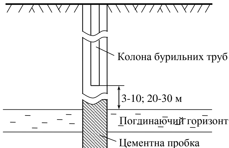
Рис. 1 Схема тампонування поглинаючого горизонту
